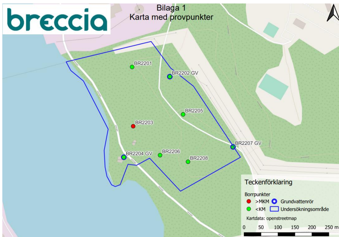
Figur 13: Provtagning av mark- och grundvatten 2022 visade att Gulliborgstippen (BR2203) innehåller föroreningshalter som överstiger riktvärden för mindre känslig markanvändning.
