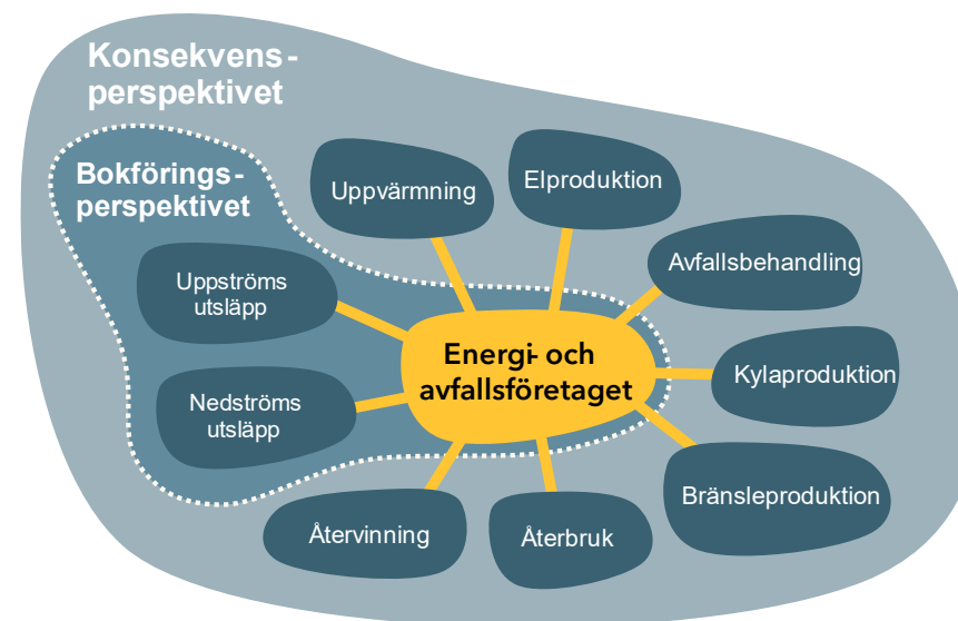
Figur 11 Skillnaden i systemgräns för konsekvens- och bokföringsperspektivet. Konsekvensperspektivet inkluderar företaget och hela dess omgivning. Bokföringsperspektivet inkluderar företaget och delar av omgivning men inte klimatpåverkan från undviken alternativ produktion tack vare företagets levererade produkter och tjänster.
