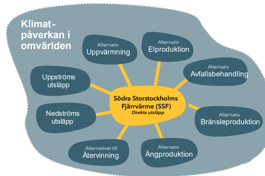
Figur 1 SSF och dess omgivning. I omgivningen både tillförs och undviks klimatpåverkan på grund av de produkter och tjänster som köps in av företaget eller levereras av företaget. Företagets egna anläggningar, transporter m.m. ger upphov till direkta utsläpp (direkt klimatpåverkan).
